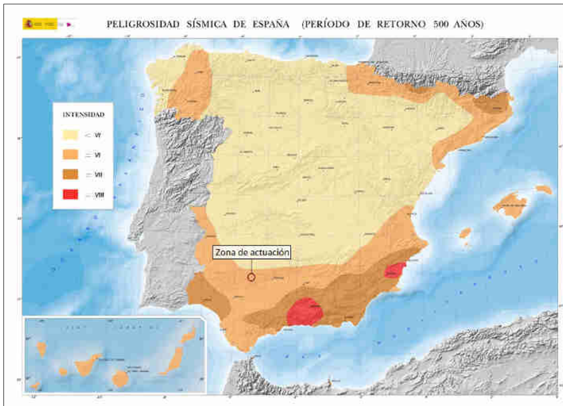
Ilustración 49. Mapa de peligrosidad sísmica de España para un periodo de retorno de 500 años. Fuente: Instituto Geográfico Nacional (IGN).
